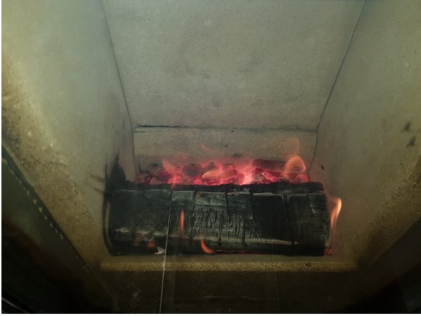
(d) Run 7, event c - collapsed log, channel at the back
