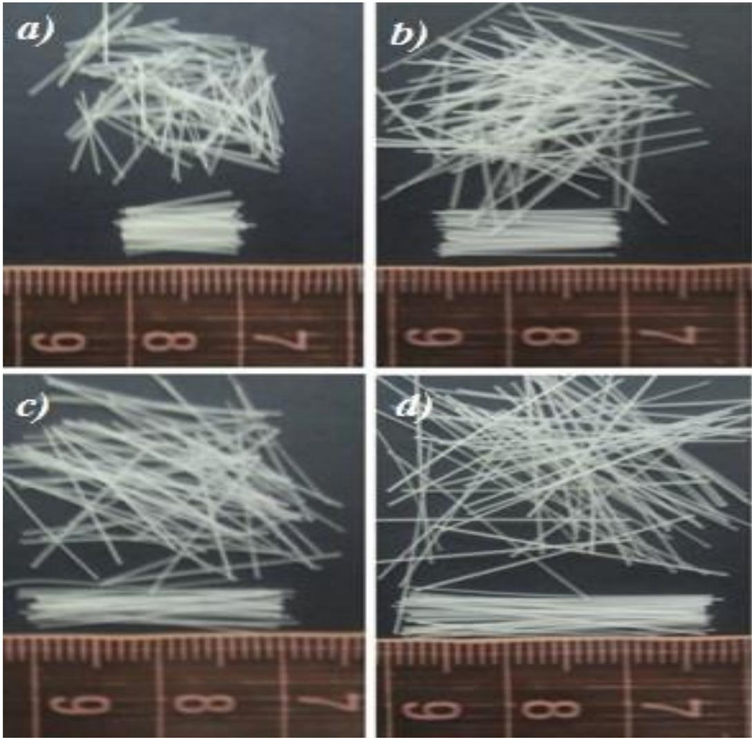
**Fig.1.** Different loose fibres (a) L=10 mm,( b) L=15 mm,( c) L= 20 mm, (d) L=25 mm
